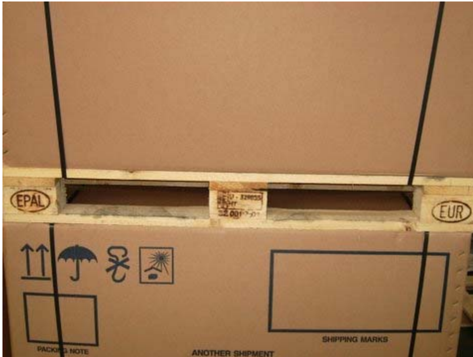
Slika 5: Pakiranje na paleto standarda ISPM-15 (Arhiv Goodyear, 2007)
