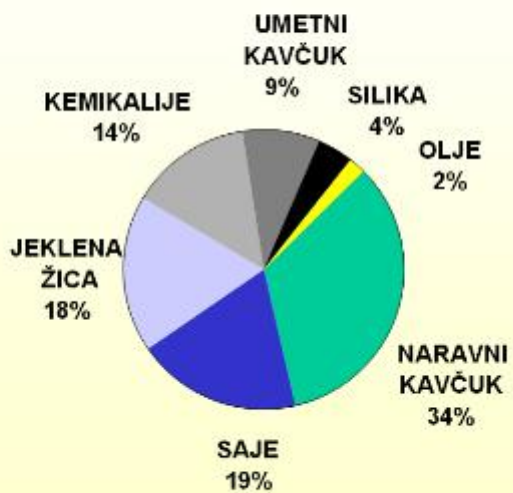
Slika 6: Sestava poltovornega avtoplašča
