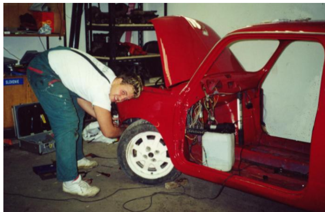
Slika 17: Montaža električne napeljave
