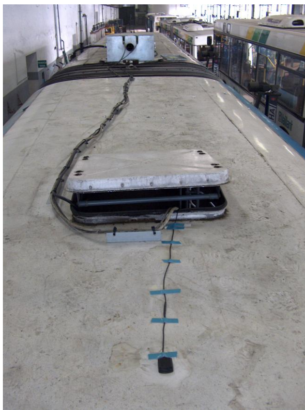
Slika 9: Namestitev komore za meritev neprosojnosti izpušnih plinov na zgibu in antene GPS na avtobusu št. 329
