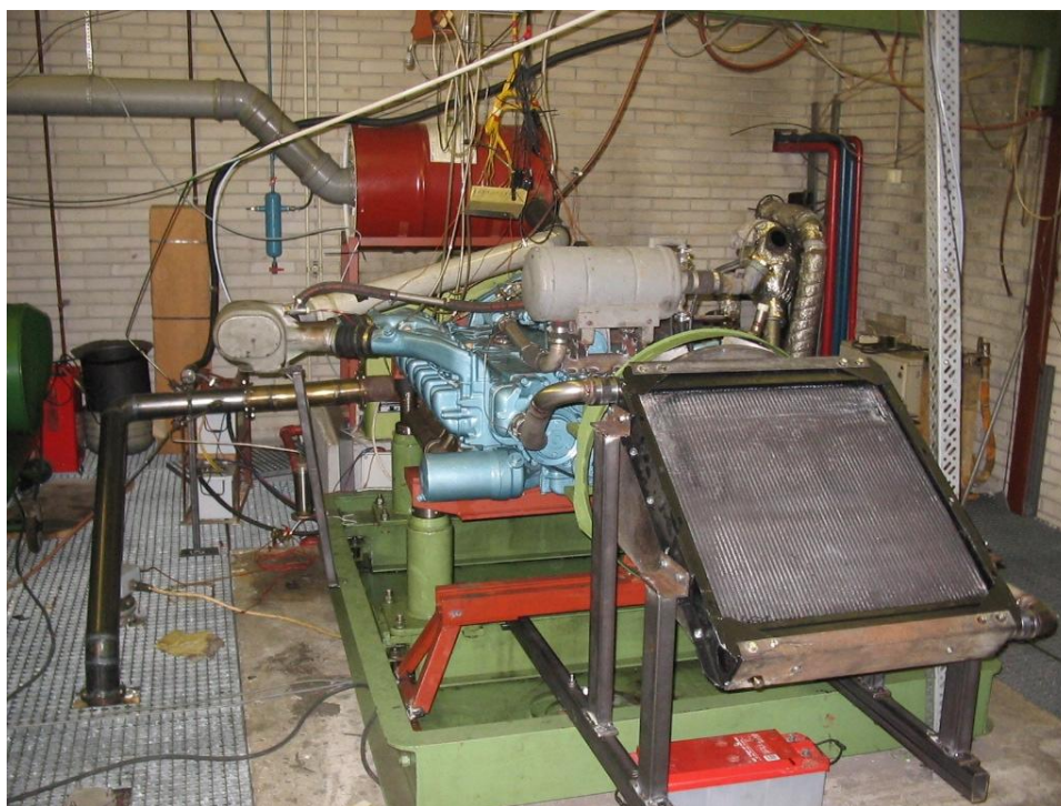
Slika 5: Motor MAN D 2566MUM na zavori na preizkuševališču
