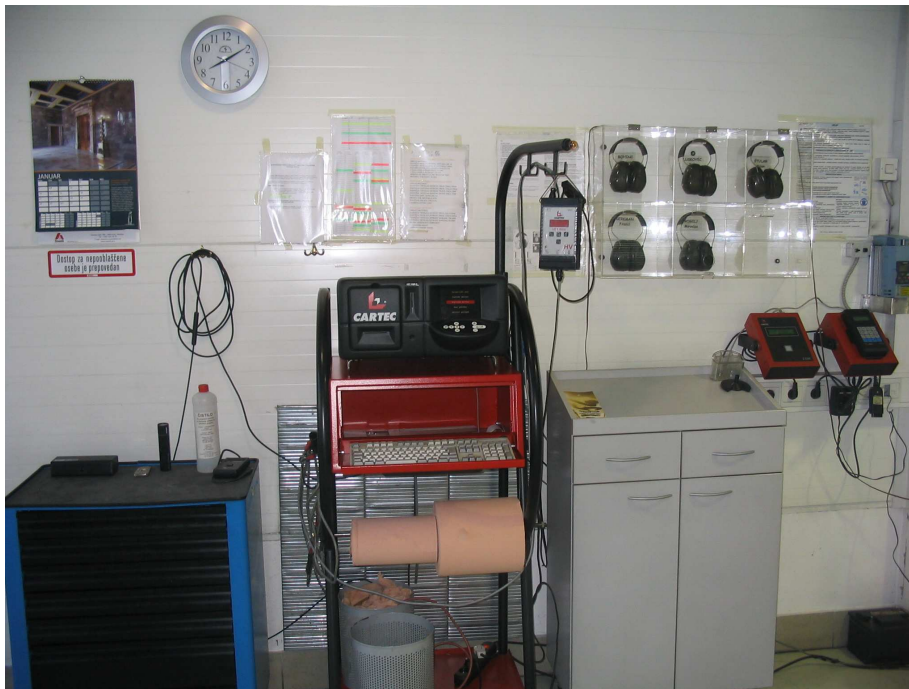
Slika 8: Naprava za merjenje dimnosti in vsebnosti škodljivih snovi
