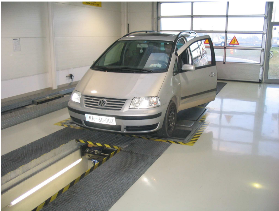
Slika 5: Merjenje zavornih učinkov
